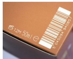
Codice a barre laser su un astuccio in cartone
