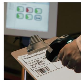
**Der gewünschte Druckauftrag kann mit einem Hands scanner im Arbeitsauftrag aufgerufen werden, und mithilfe von CLARiSUITE® können die Felder für die erforderlichen Codedaten automatisch ausgefüllt werden.**
