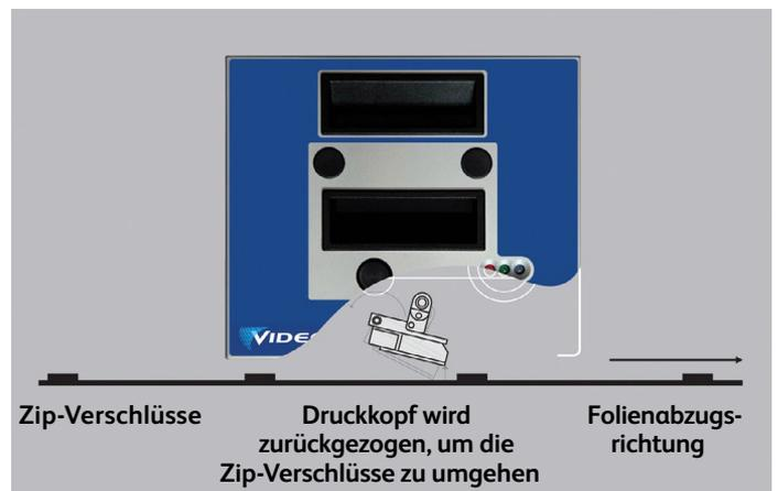
**Durch eine einfache Einstellung in der Software kann der Thermodruckkopf um 4,5 mm eingezogen werden**
