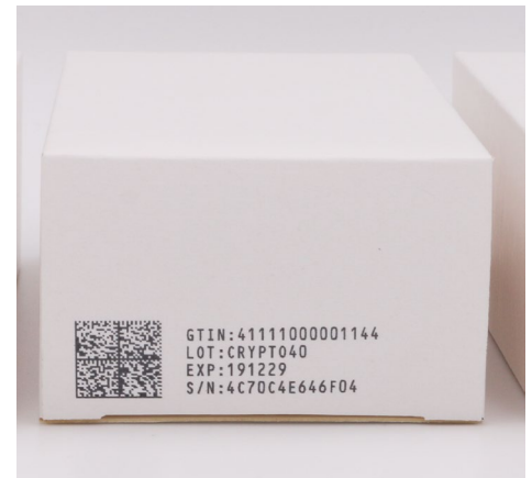
Ein typischer Cryptocode mit einer Symbolgröße von 36x36 Modulen mit einem Wolke m610 advanced gedruckt.
