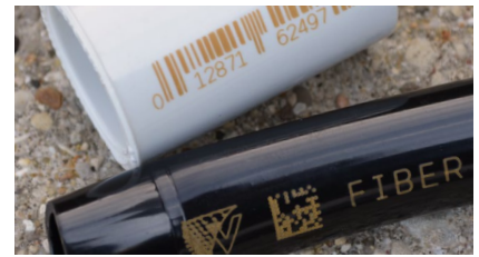
Laser auf Rohren
