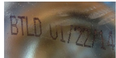
Faible adhérence de l'encre - code maculé
