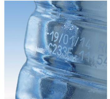
Le temps de marquage se calcule généralement en ajoutant le temps de marquage réel du laser au temps nécessaire pour passer d'un caractère à l'autre. Un autre moyen de maximiser le temps de marquage disponible consiste à optimiser le temps de marquage réel par rapport au temps de saut. Le temps de saut est fixe, et se compose du temps de saut, d'attente, de décélération et d'accélération nécessaires aux galvanomètres.
