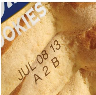
**Le codage à transfert thermique répond aux besoins de marquage sur emballages souples. L'impression génère un code haute résolution et facile à lire sur l'emballage. La qualité du code reste constante et ne se dégrade pas, ainsi que la structure du film d'emballage.**
