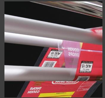
La technique d'impression à Transfert Thermique repose sur l'utilisation d'une tête d'impression et d'un ruban de transfert thermique. La tête d'impression comprend un élément thermique vitrocéramique qui recouvre une rangée de pixels correspondant à une résolution de 12 points d'impression par mm, ce qui permet d'imprimer des codes à haute résolution.
