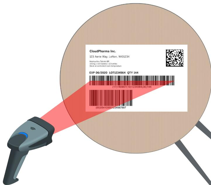
**Idéal pour les cartons qui se trouvent sur des palettes, puisqu'il est ainsi possible de les scanner dans diverses orientations**
