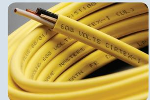
Impression au jet d'encre à fort contraste sur PVC, polyéthylène, polyéthylène réticulé, polypropylène, etc.
