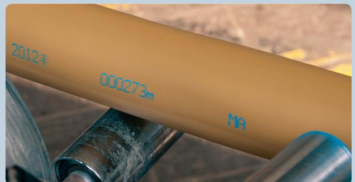
*Codage au jet d'encre à fort contraste sur câble de gros calibre*
