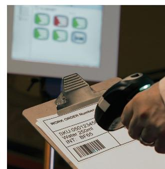
**Un scanner portatif peut être utilisé pour appeler la tâche d'impression à partir d'un ordre de fabrication et, avec CLARiSUITE®, il permet d'importer automatiquement les données de codage requises.**
