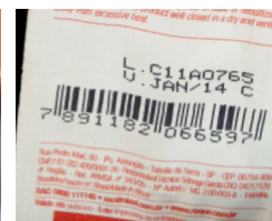
Code à barres imprimé par jet d'encre continu sur un emballage sous blister
