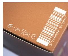
Code à barres imprimé au laser sur carton
