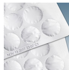
Code obtenu par impression à jet d'encre thermique sur une feuille à blister
