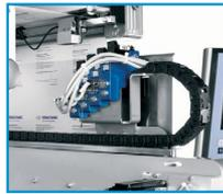
Têtes d'impression Wolke bleues montées sur la bande d'une thermoformeuse. Les têtes d'impression se déplacent de droite à gauche, codant plusieurs emballages en un seul passage.
