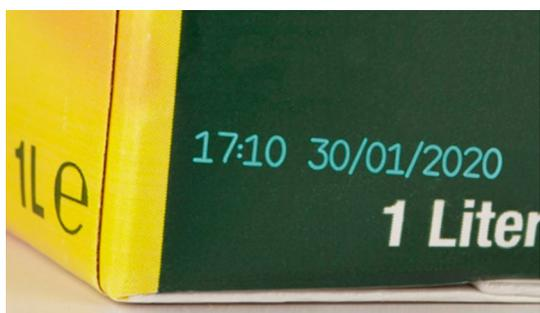
**L'utilisation de lasers pour appliquer des codes propres et nets est courante dans les environnements difficiles de production laitière. Le marquage laser permet aux fabricants de produits laitiers de bénéficier d'une plus grande disponibilité, de réduire les opérations de maintenance et d'améliorer la lisibilité de la marque. Répondez aux besoins d'une identification plus précise et lisible des produits grâce à une solution de marquage laser permanent de Videojet.**
