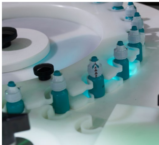
Transport sur roue étoilée pour le contrôle positif des flacons pendant le marquage
