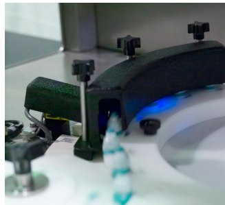
Marquage des flacons sur le fond ; écran de protection du laser en noir
