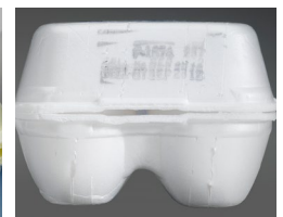
Marquage de mauvaise qualité sur le carton
