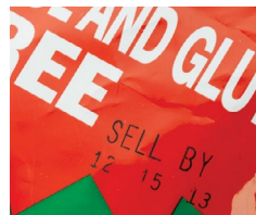
Code de mauvaise qualité obtenu par estampage à chaud
