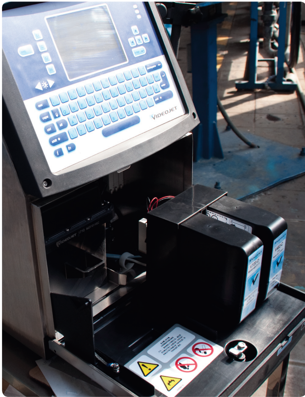
宝胜的新型 Videojet 1710 喷码机上的 Smart Cartridge™ 供墨系统
