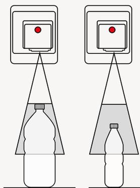
在完成初始工作模板设定后可自动调节焦距，无需上下移动激光机，从而减少人为错误和操作人员干预。
