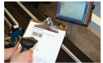
作业数据可通过手持扫描仪发送到喷码机
