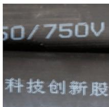
中国宝胜集团与伟迪捷密切协作，力图找到能够满足其需求的解决方案，可在深色电缆上喷印高对比度颜料墨水编码，经得起艰苦的产品生命周期和恶劣喷码环境的考验。
