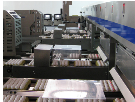
安装在分级机上的 CIJ 喷码机
