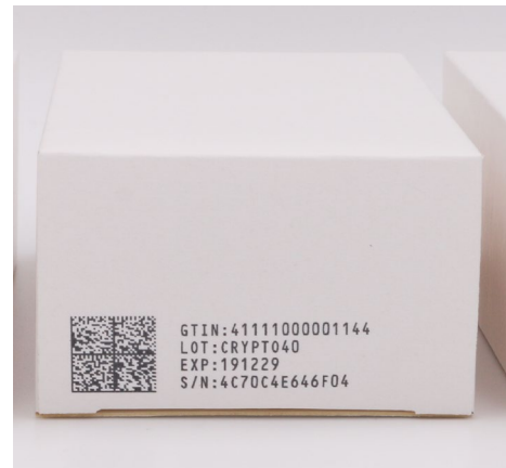
使用 Wolke m610 advanced 喷印的符号尺寸为 36x36 模块的典型加密编码。
