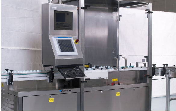
安装有伟迪捷紫外激光打码机的 FP Developments 包装解决方案
