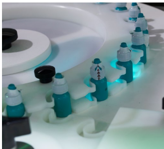
星轮运输可在标识过程中对瓶子进行完全控制
