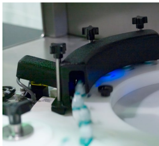
在瓶子底部进行标识；激光打码机防护罩显示为黑色
