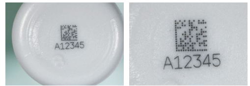
在 HDPE 瓶上进行高对比度紫外激光打码标识
