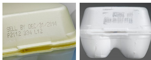
在聚苯乙烯蛋箱上进行喷墨喷码
