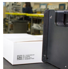
Código DataMatrix 2D em uma caixa de papelão revestida
