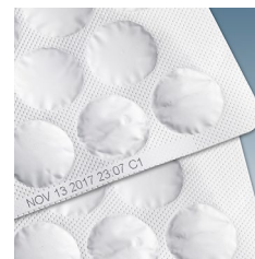
Código de jato de tinta térmico em lâmina de blister
