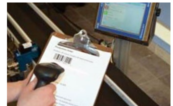
Dados de trabalhos podem ser enviados para a impressora por meio de um leitor portátil
