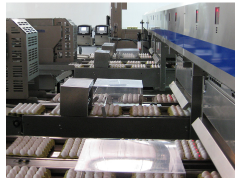
Impressoras de CIJ instaladas no graduador
