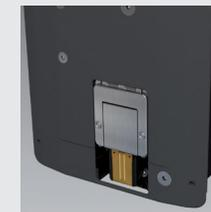
Si la producción continúa, el deslizador Cartridge Readiness System se abre automáticamente. Después, la Wolke m600 universal puede volver a crear códigos de alta calidad sin ninguna intervención.
