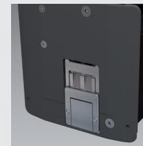
El CRS cierra el cabezal de impresión tras un plazo de tiempo programado por el usuario. Se crea un sello que ayuda a evitar que la tinta se seque en la matriz de impresión.
