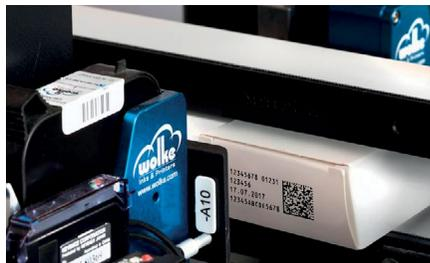
**Con un diseño racional y una construcción muy práctica, la impresora m600 oem proporciona una excelente versatilidad para integrarse en cabinas de control de máquinas de envasado, junto con eficaces funciones de seguimiento y trazabilidad.**
