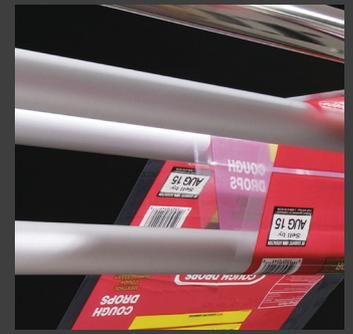
La TTO usa un cabezal de impresión térmico y una cinta de transferencia térmica. El cabezal de impresión incluye un revestimiento cerámico, que cubre una fila de píxeles térmicos con una resolución de 12 puntos de impresión por mm, de modo que ofrece códigos de alta resolución.
