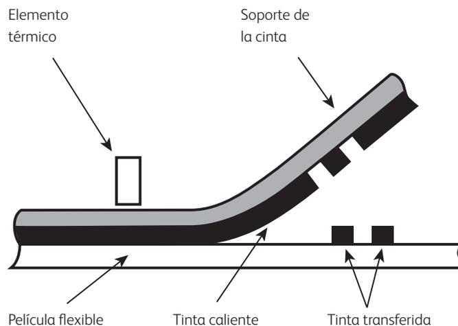
TTO es una tecnología de codificación de contacto, lo que significa que debe tocar la etiqueta o película de envasado flexible para producir un código. Para cumplir este requisito, la unidad TTO se instala (usando un soporte y algunas partes auxiliares) directamente sobre la máquina de envasado o el sistema de etiquetado, normalmente muy cerca del punto de envasado.
