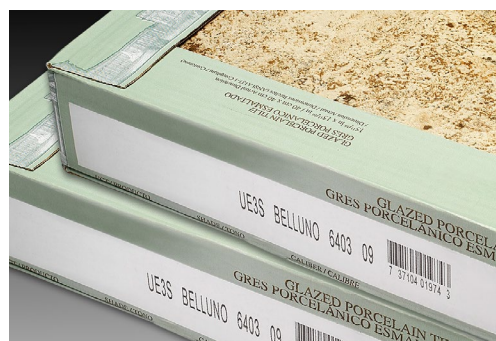
Inyección de tinta de caracteres grandes de alta resolución sobre materiales corrugados de color blanco
