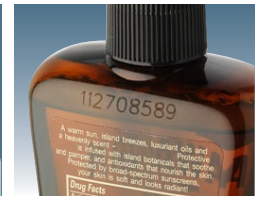
Código láser directamente en una botella con pulverizador
