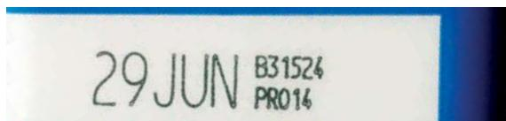
Лазерная маркировка на рукавах с использованием технологии Datalase™
