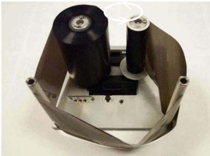
Figura 5-17. Installazione della bobina del nastro
