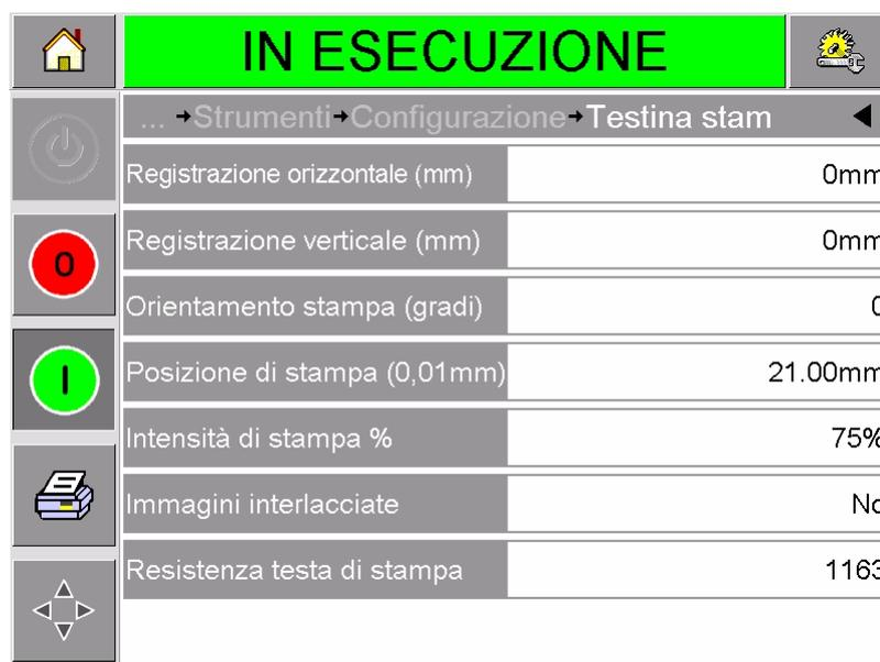
Figura 4-13. Pagina di impostazione della testina di stampa per funzionamento con movimento continuo
