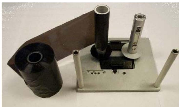
Figura 5-15. Rimozione delle bobine del nastro
