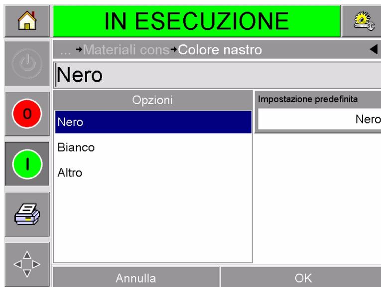
Figura 5-19. Impostazione del colore del nastro
