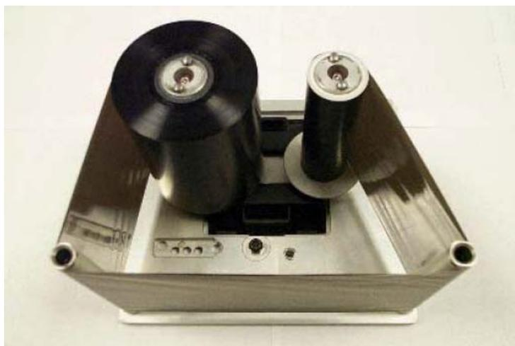
Figura 5-18. Installazione della bobina del nastro
