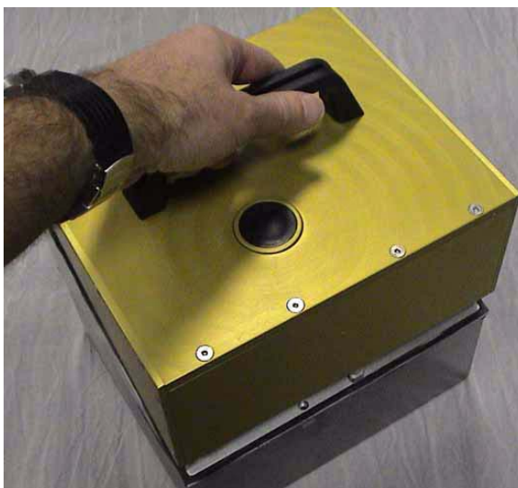
Figura 5-12:Remoção do Cassete IP
