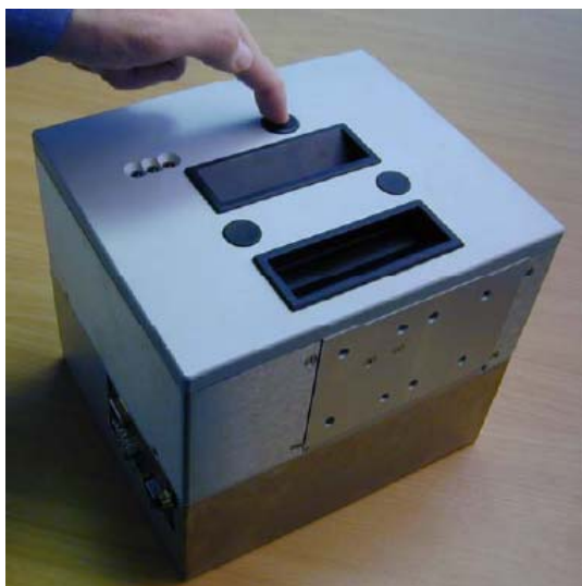
Figura 5-4: Destravamento do Cassete
