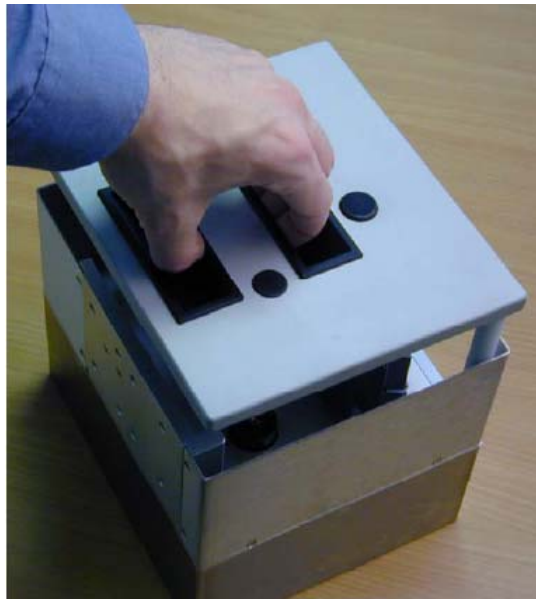
Figura 5-6: Remoção do Cassete
