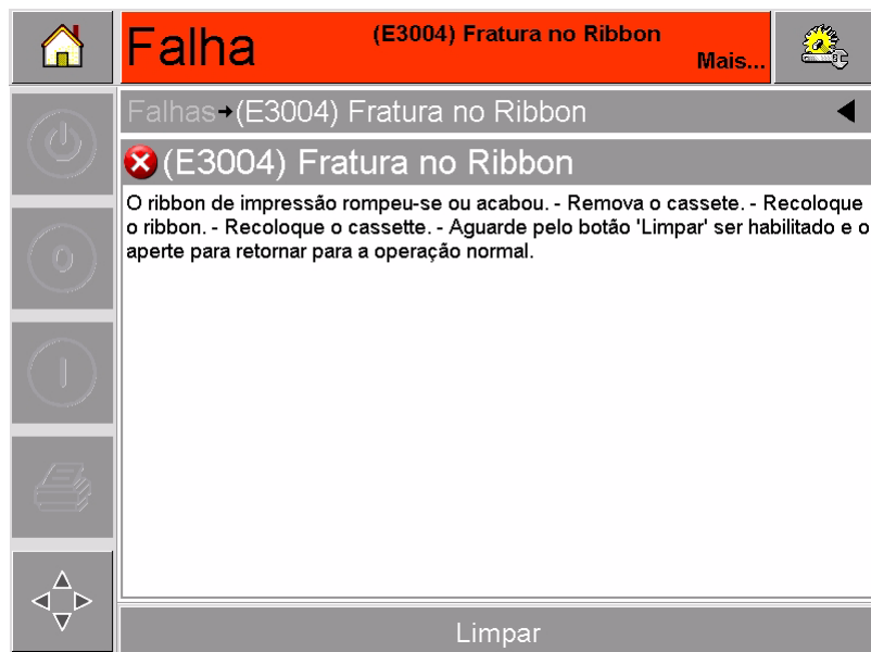
Figura 5-3: Tela de Detalhes da Falha
