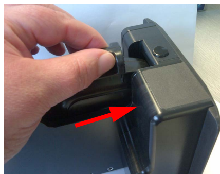
Figura 6-22: Inserimento della cartuccia nel suo alloggiamento
