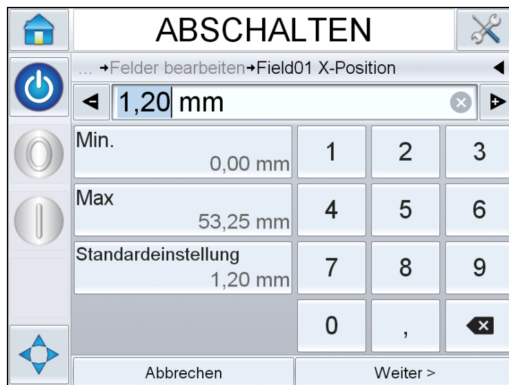
Abbildung 6-11: Schnellposition bearbeiten – X-Position
