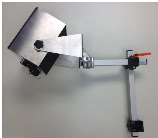
Abbildung 3-16: Montagesystem der Steuereinheit
