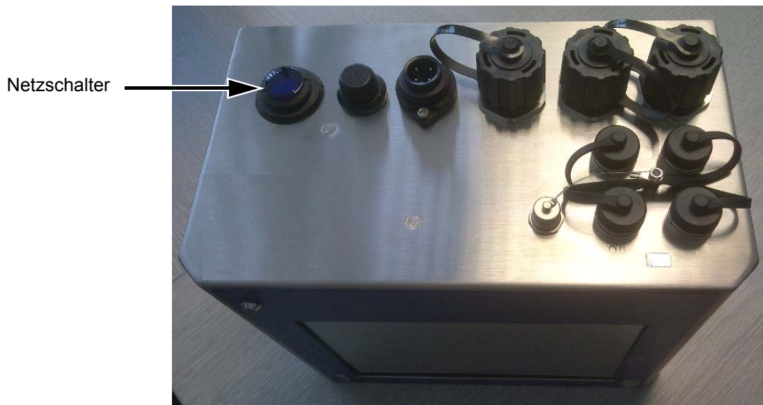
Abbildung 5-6: Netzschalter des Druckers
