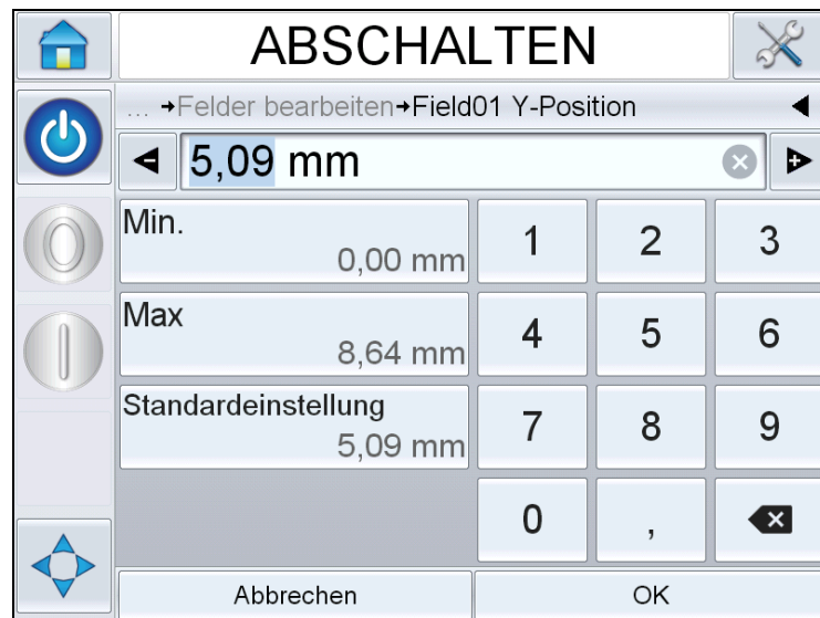
Abbildung 6-12: Schnellposition bearbeiten – Y-Position
