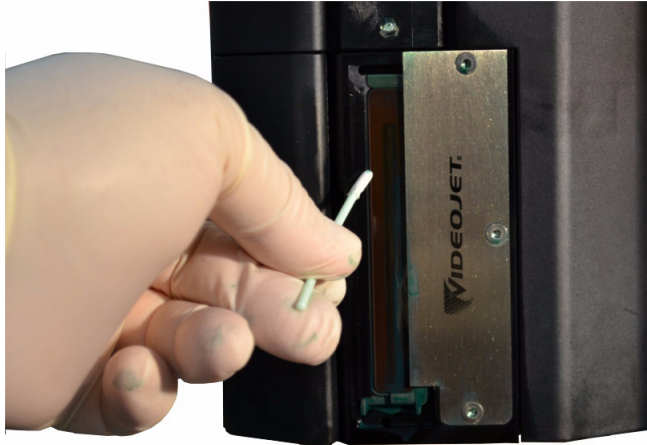
Şekil 4-23: Boşaltma Kanalının Temizlenmesi (Videojet 2351/2361)
