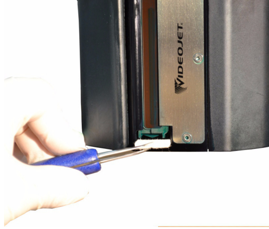
Şekil 4-25: Kalıntı Tamponunun Çıkarılması (Videojet 2351/2361)
