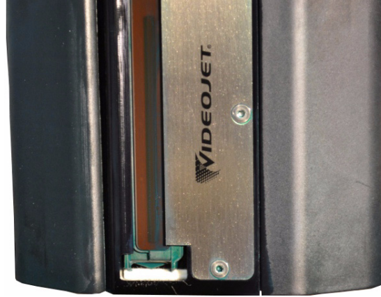
Şekil 4-27: Yerleştirilmiş Kalıntı Tamponu (Videojet 2351/2361)
