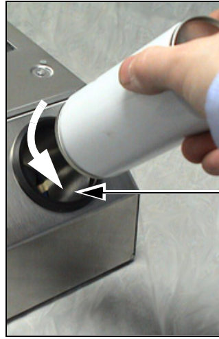
Şekil 4-12: Boş Mürekkep Kutusunun Çıkarılması
