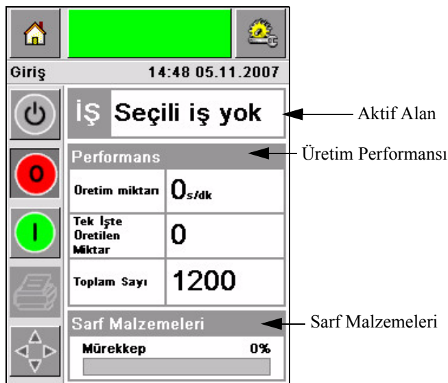
Şekil 3-4: Performans ve Sarf Malzemeleri Durumu
