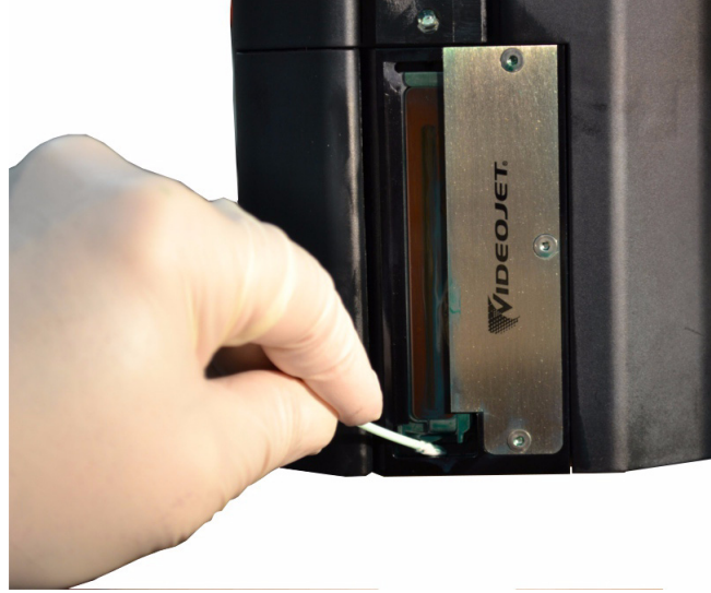
Şekil 4-26: Toplayıcı Kabın Temizlenmesi (Videojet 2351/2361)
