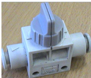
Zamknięty kranik zaworu
