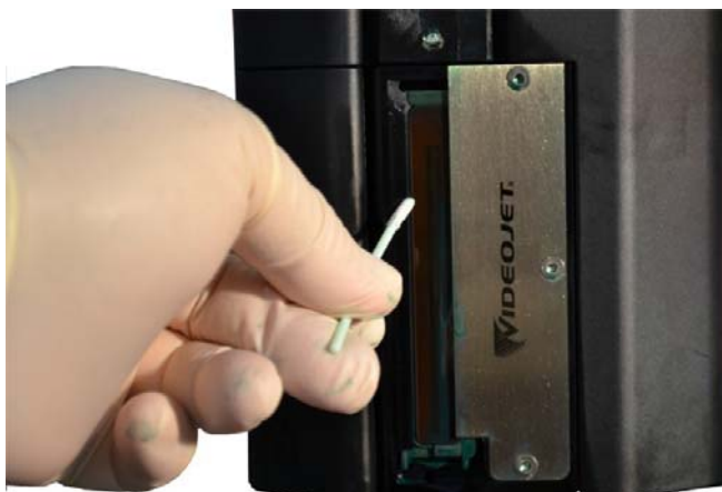
Rysunek 4-23: Czyszczenie kanału odpływowego (Videojet 2351/2361)
