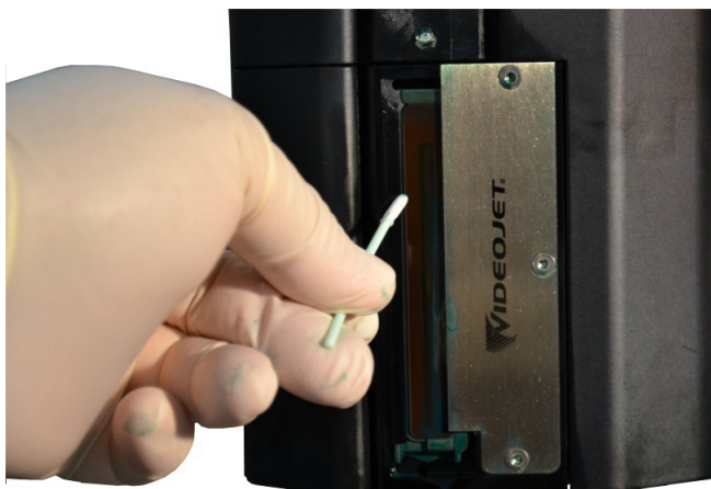
Figur 4-23: Rengjøring av dreneringskanalen (Videojet 2351/2361)
