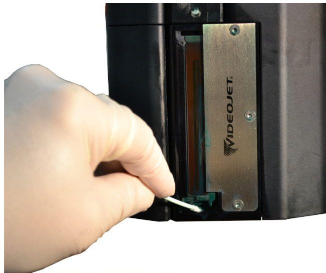
Figur 4-26: Rengjøre oppsamlingskoppen (Videojet 2351/2361)
