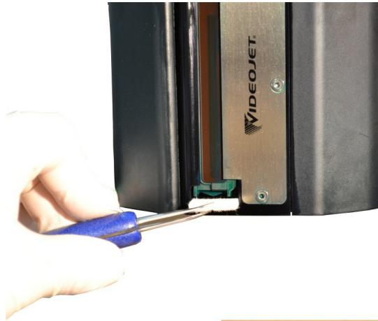
Figur 4-25: Fjerning av nedfallspute (Videojet 2351/2361)
