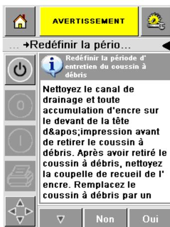
Figure 4-28 : Retrait du tampon de récupération des salissures
