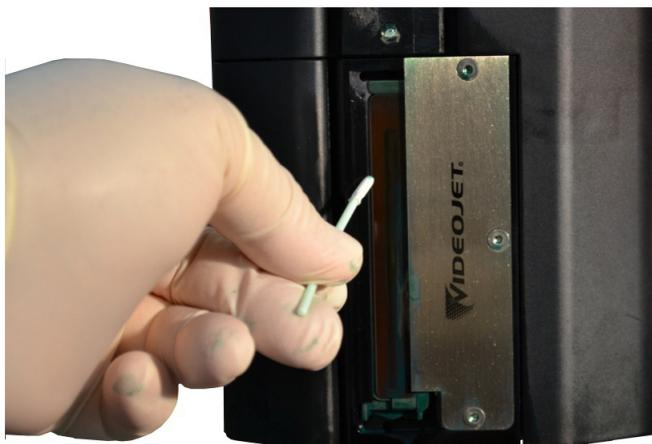
Figure 4-23 : Nettoyage du conduit d'évacuation (Videojet 2351/2361)
