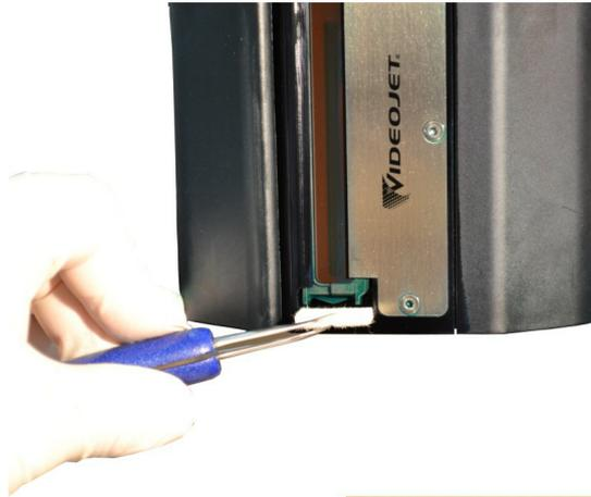
Figure 4-25 : Retrait du tampon de salissures (Videojet 2351/2361)
