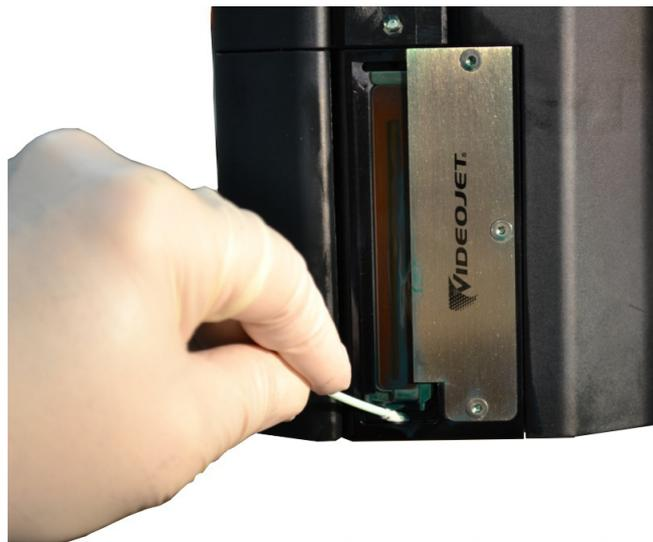
Figure 4-26 : Nettoyage de la coupelle de récupération (Videojet 2351/2361)
