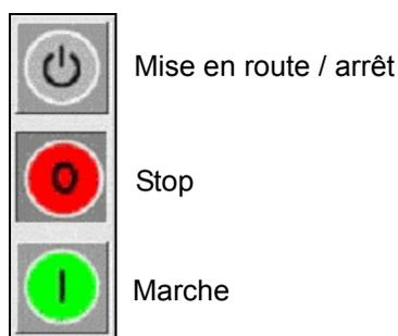
Figure 3-3 : Boutons du panneau de contrôle
