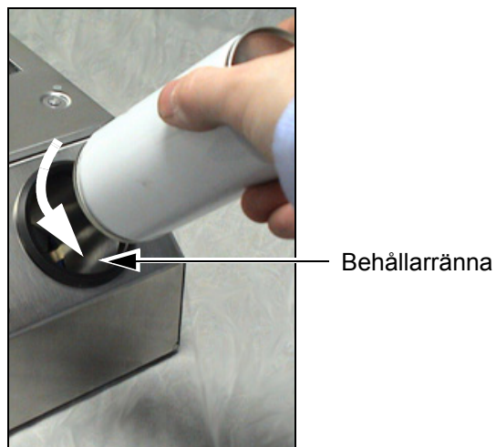
Figur 4-12: Ta bort en tom bläckbehållare
