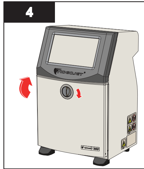
4. Mürekkep bölmesinin kapağını kapatın. Yatay konumdaki düğmeyi saat yönünde dikey konuma döndürerek mürekkep bölmesinin kapağını kilitleyin.
