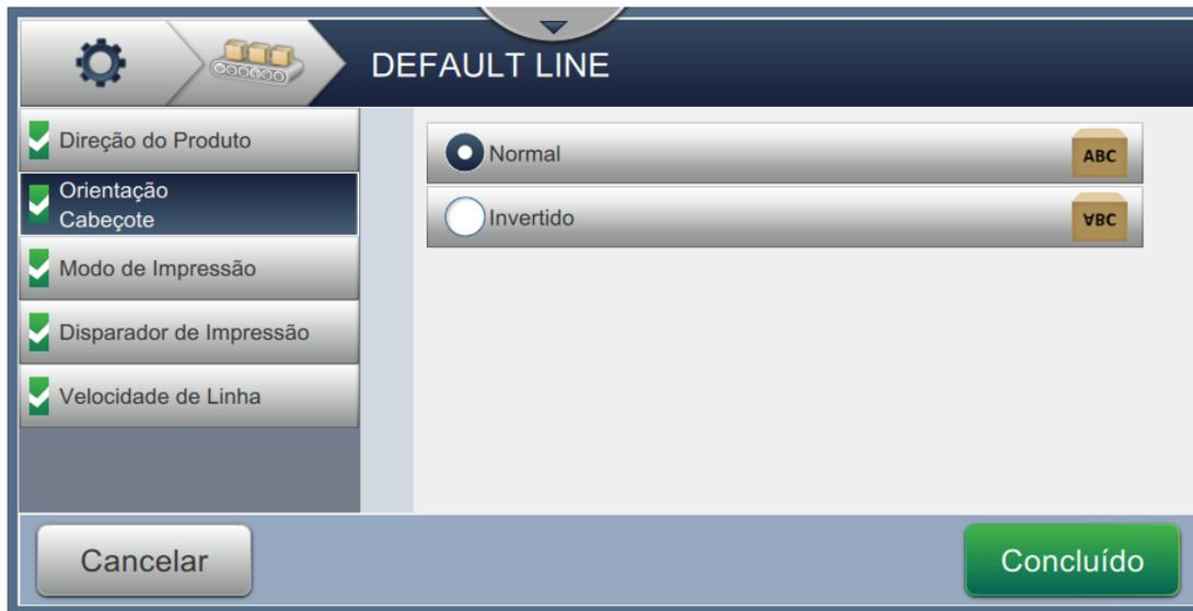
Figura 6-29: Configuração de linha – Orientação do cabeçote de impressão
