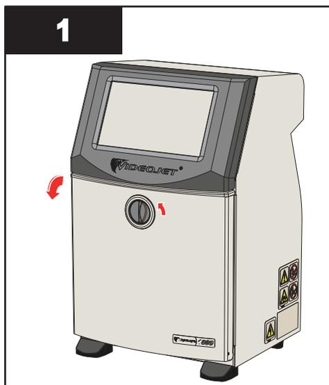
1. Gire o botão de posição vertical no sentido anti-horário para a posição horizontal e destrave a tampa. Abra a tampa do compartimento de tinta.
