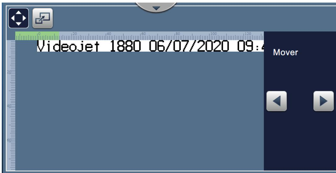
Figura 8-2: Como ajustar a posição de impressão – Mover
