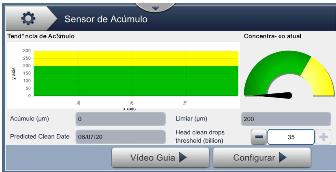
Figura 6-26: Sensor de acúmulo de tinta
