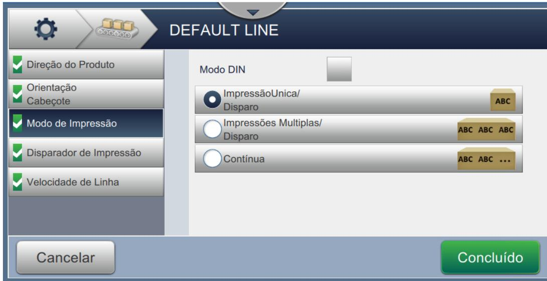
Figura 6-30: Configuração de linha – Modo de impressão
