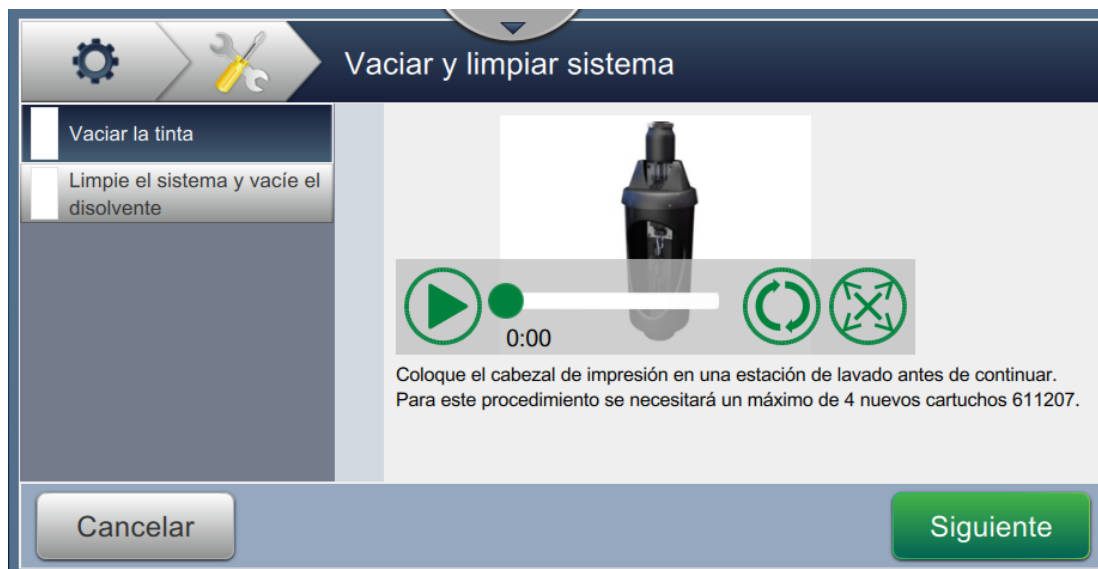
Figura 7-3: Pantalla Vaciar y limpiar sistema
