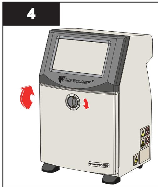
4. Schließen Sie die Tür des Tintenfachs. Drehen Sie den horizontalen Regler im Uhrzeigersinn in die Vertikale, um die Tür des Tintenfachs zu verriegeln.
