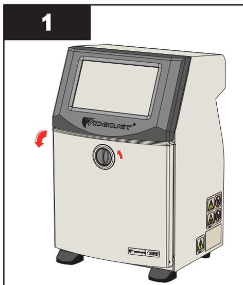
1. Drehen Sie den Regler in der vertikalen Position gegen den Uhrzeigersinn in die horizontale Position und entriegeln Sie die Tür. Öffnen Sie die Tür des Tintenfachs.
