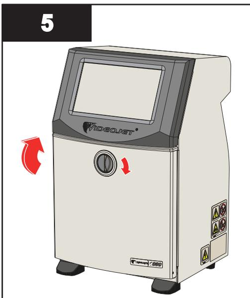
5. Schließen Sie die Tür des Tintenfachs. Drehen Sie den horizontalen Regler im Uhrzeigersinn in die Vertikale, um die Tür des Tintenfachs zu verriegeln.
