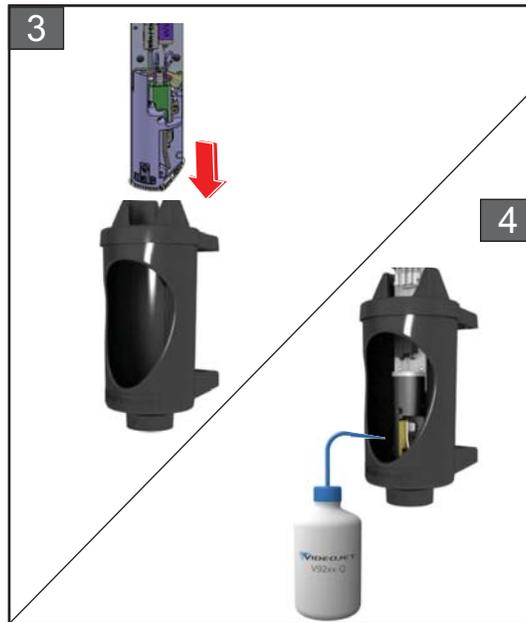
3. Coloque o cabeçote de impressão na estação de limpeza com um recipiente devidamente aterrado abaixo.
