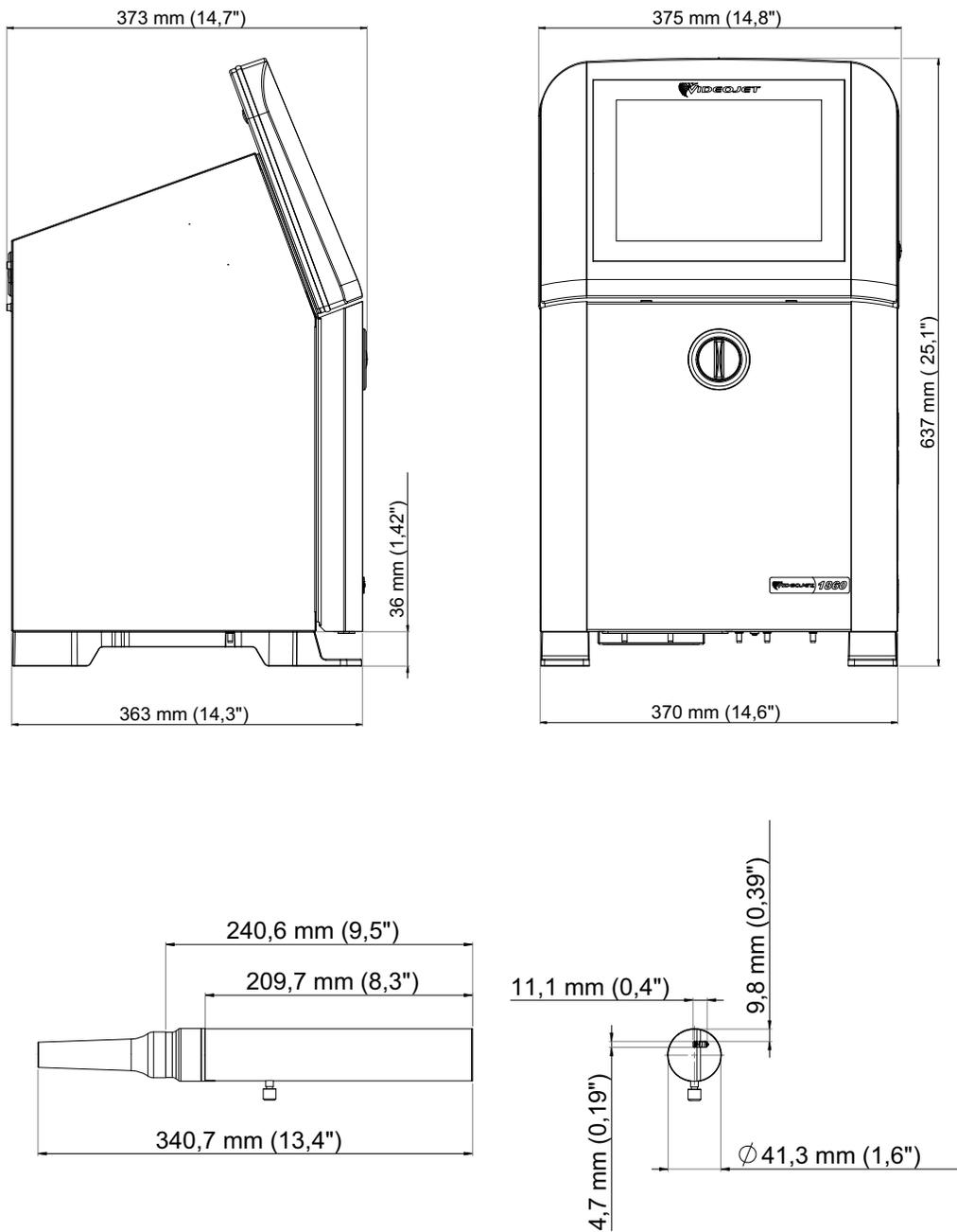
Figura A-1: Dimensões da impressora
