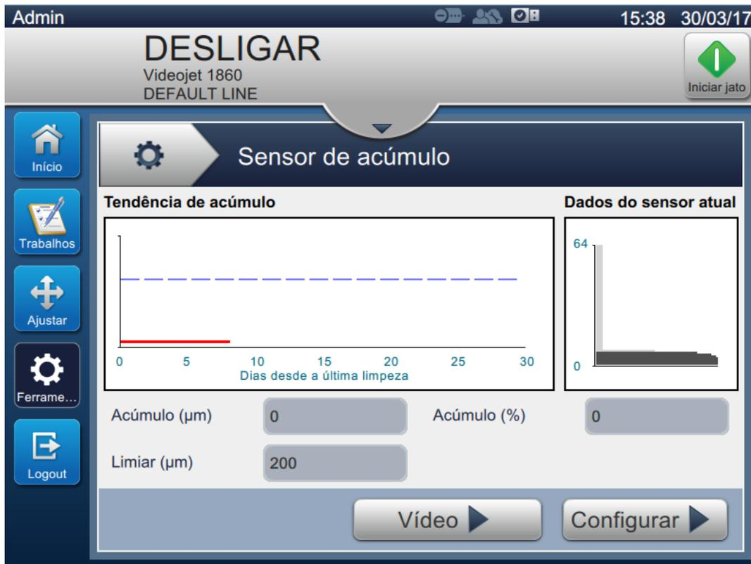
Figura 6-25: Sensor de acúmulo de tinta
