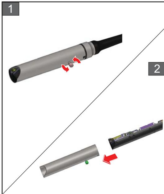
1. Desaperte o parafuso no cabeçote de impressão na direção indicada.
