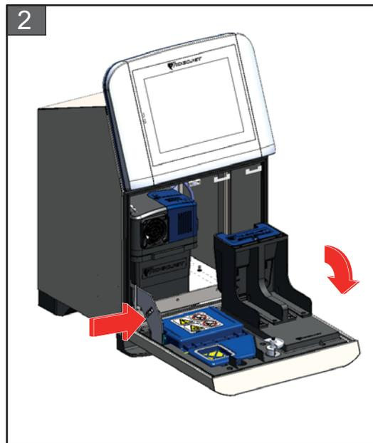
2. Pressione o trinco ao lado do compartimento de tinta para abrir a porta completamente.
