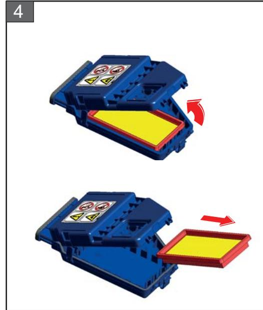
4. Abra a tampa do filtro de ar e remova o elemento do filtro de ar da unidade de filtro de ar.
