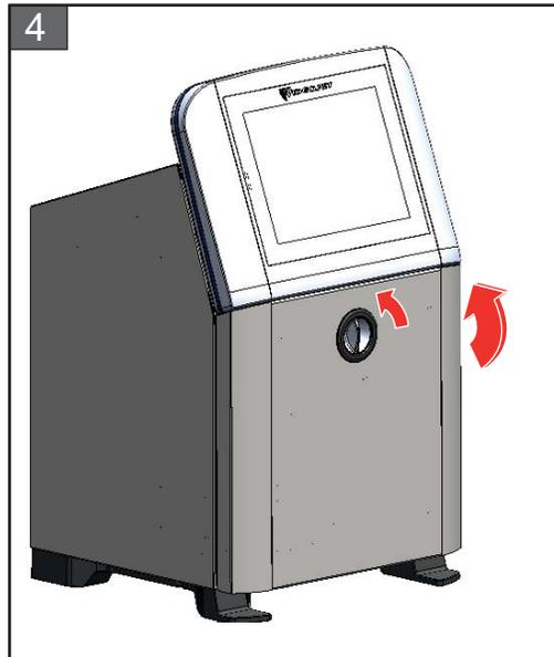
4. Feche a porta do compartimento de tinta. Gire o botão horizontal no sentido anti-horário para a posição vertical a fim de travar a porta do compartimento da tinta.
