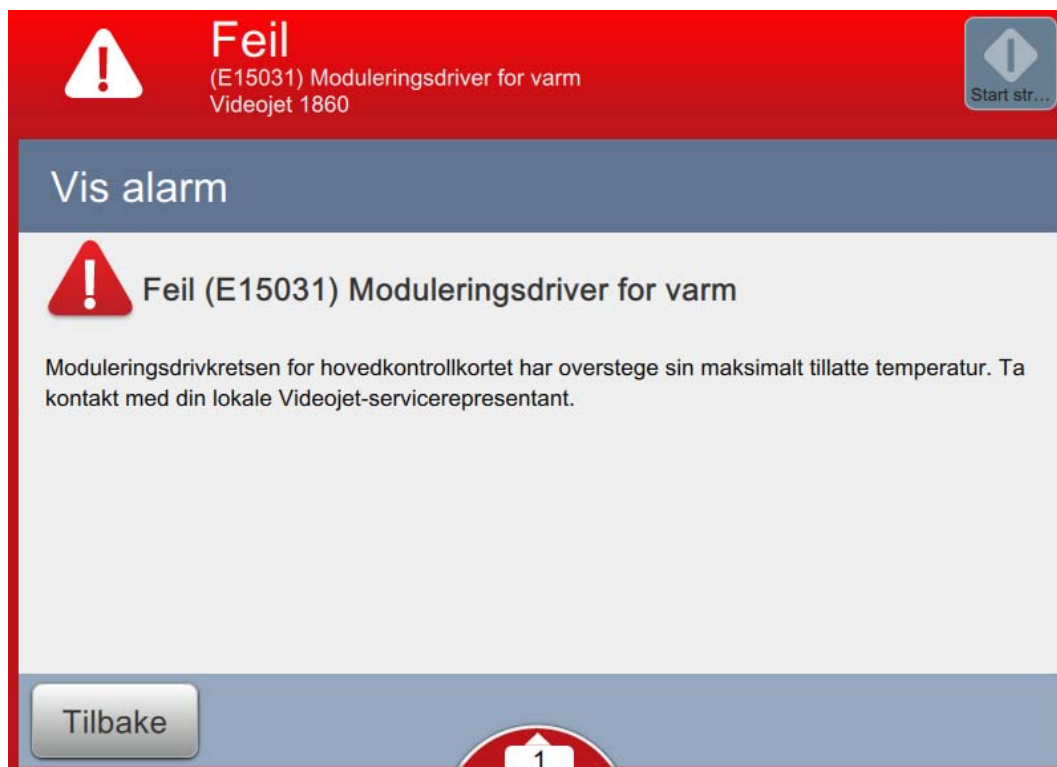
Figur 8-8: Skjerm bilde for informasjon om feil
