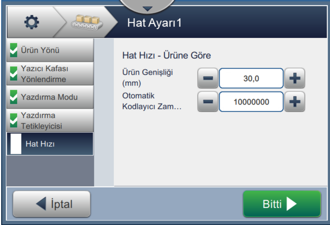
Şekil 6-36: Hat Hızı - Ürün Boyutu/Zaman Ayarları ile Ölçüm
